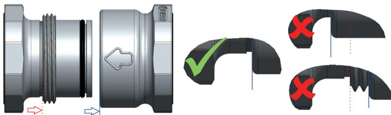
Abb. 23: Ausrichtung prüfen
